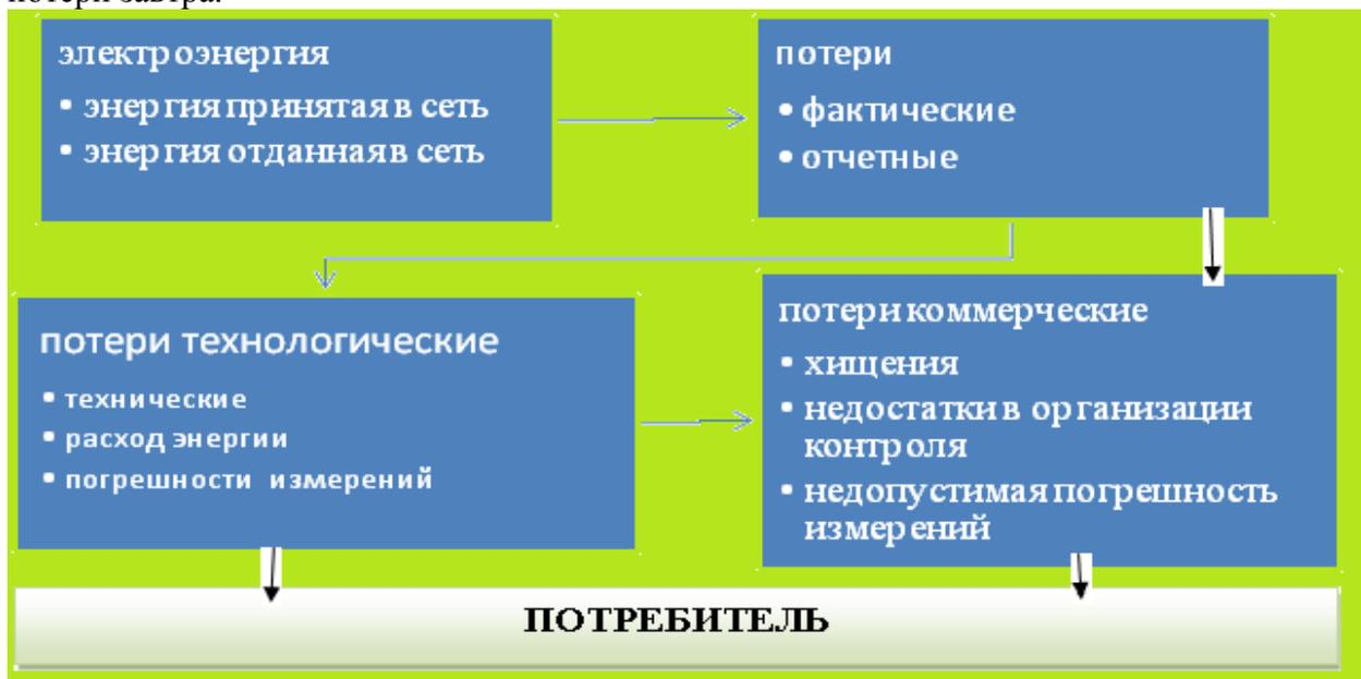
Рисунок 3. Структура потерь электроэнергии на стадиях передачи и распределения
